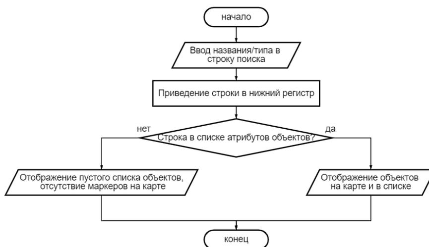
Рис. 3. Блок-схема алгоритма фильтрации объектов
