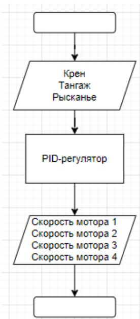
Рис. 4. Обобщенный алгоритм кадра для симулятора БПЛА
