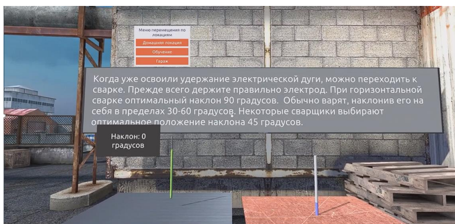
Рис. 4. Обучающий материал удерживания электрода
