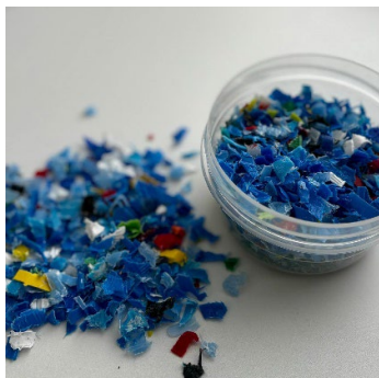
Рис. 3. Измельченные изделия из первичной гранулы ПНД
