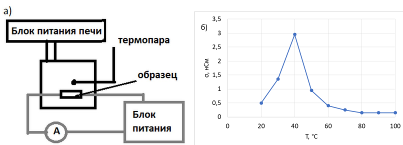
Рис. 1. а) установка для нагрева, б) зависимость проводимости от температуры.
