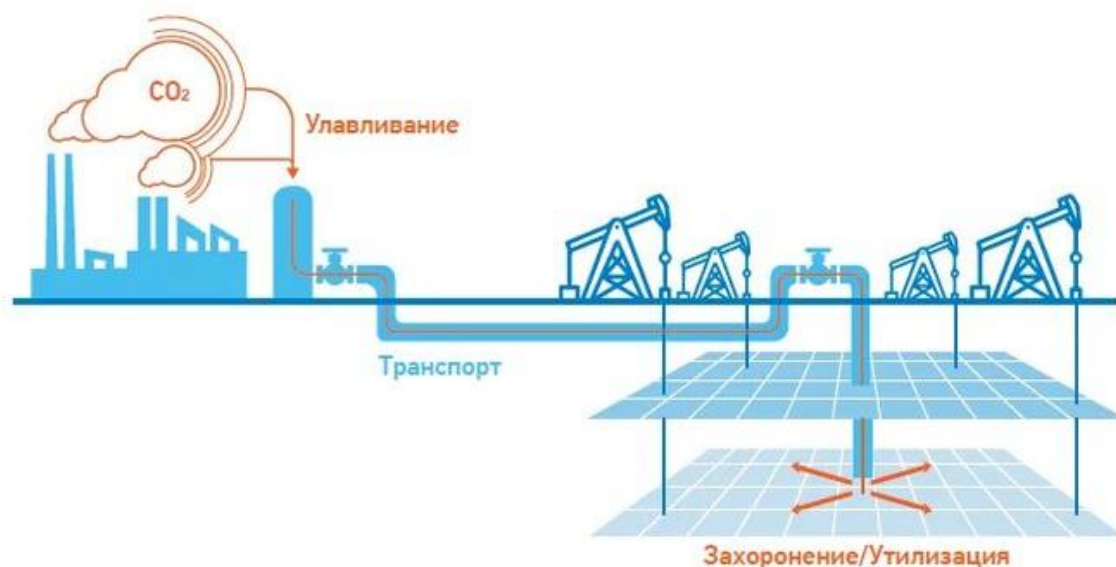
Рис. 1. Схема проекта CCUS с последующим использованием \text{CO}_2
