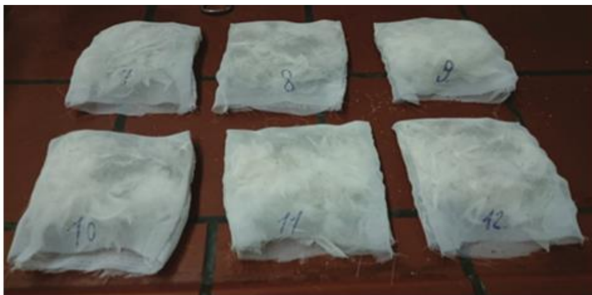
Рис. 2. Сорбционные подушки с наполнителем из куриных перьев и сепиолитового порошка [2]
