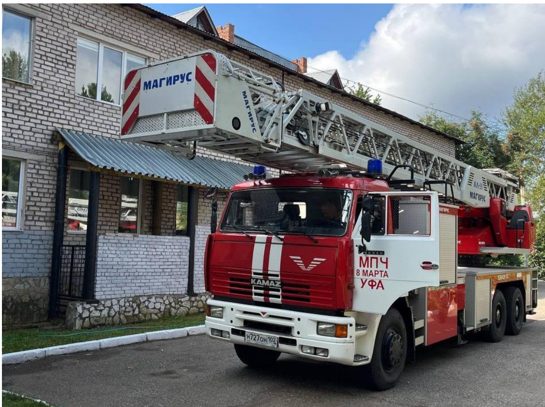
Рис. 1. Пожарная автолестница АЛ-55 МАГИРУС
