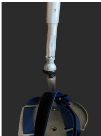
Рис. 2. Голеностопный рычаг экзоскелета
