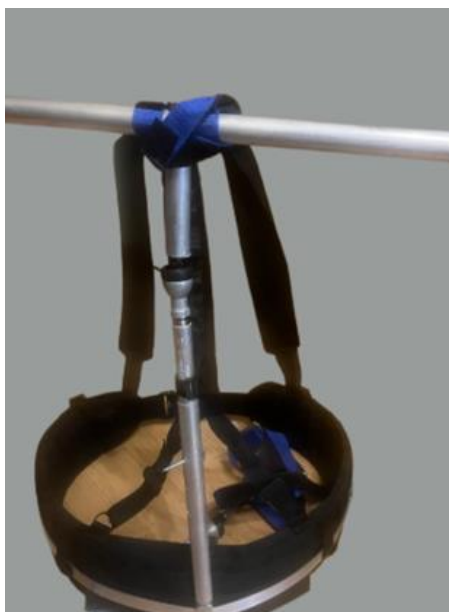
Рис. 1. Опорная часть экзоскелета
