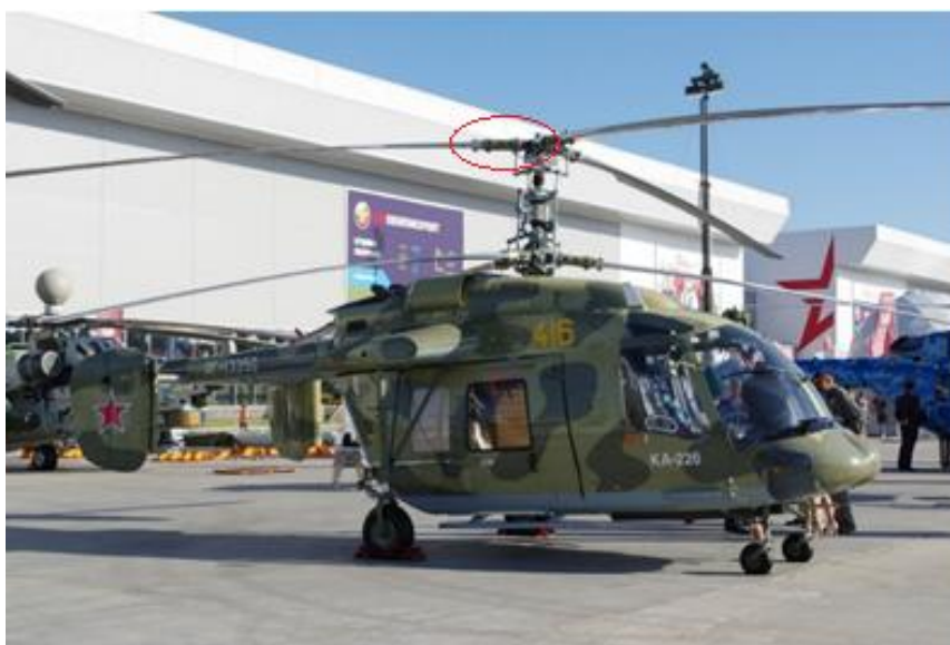
Рис. 1. Вертолет Ка-226 с указанием расположения торсиона
