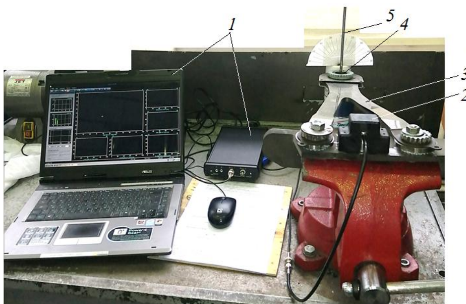
Рис. 3. Установка для испытания торсионов:
