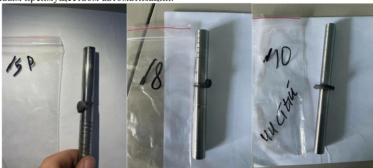
Рис. 4. Сваренные образцы из титанового сплава ВТ6
