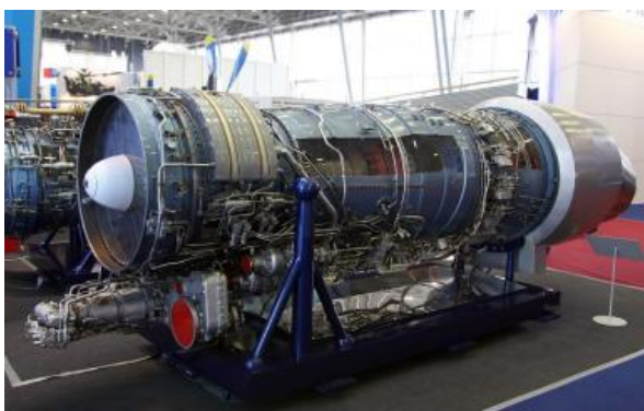
Рис. 1. Турбореактивный двухконтурный двигатель АЛ-31Ф
