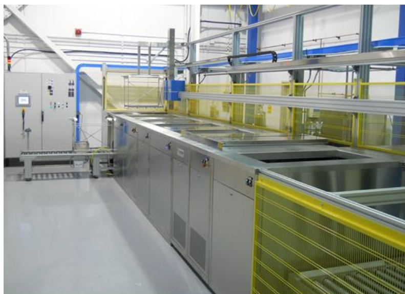
Рис. 2. 6-и позиционная автоматическая линия очистки от Novatec S.r.l
