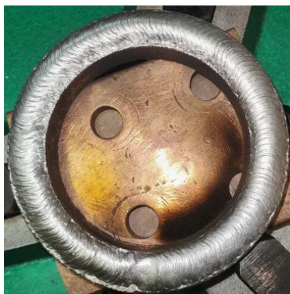
Рис. 4. Результаты наплавки: а – образец №1, б – образец №2
