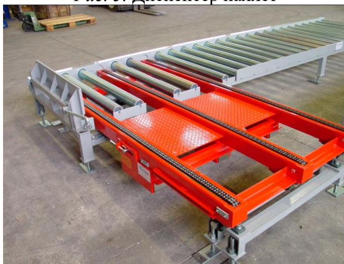
Рис. 6. Напольный роликовый конвейер для поддонов
