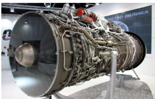
Рис. 2. Турбореактивный двухконтурный двигатель АЛ-41Ф1
