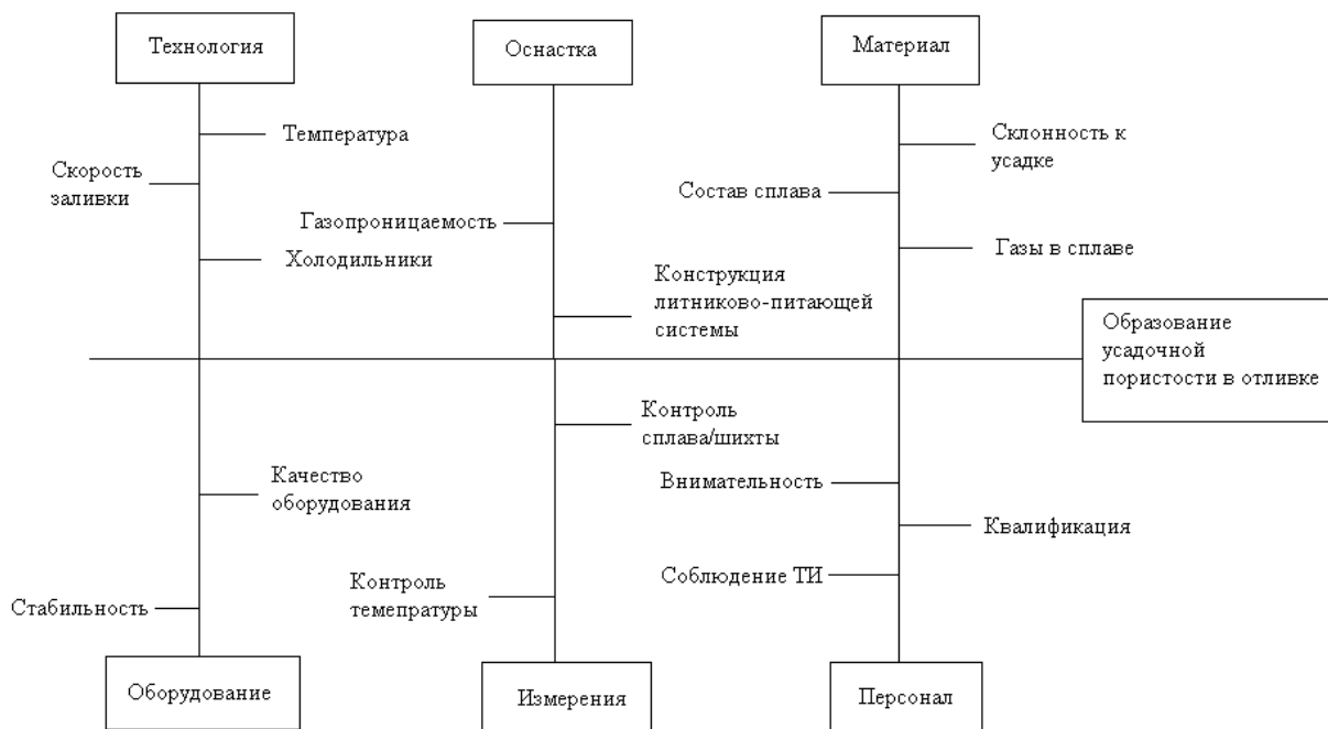
Рис. 2. Причинно-следственная диаграмма Исикавы для анализа дефекта усадочной пористости в отливках
