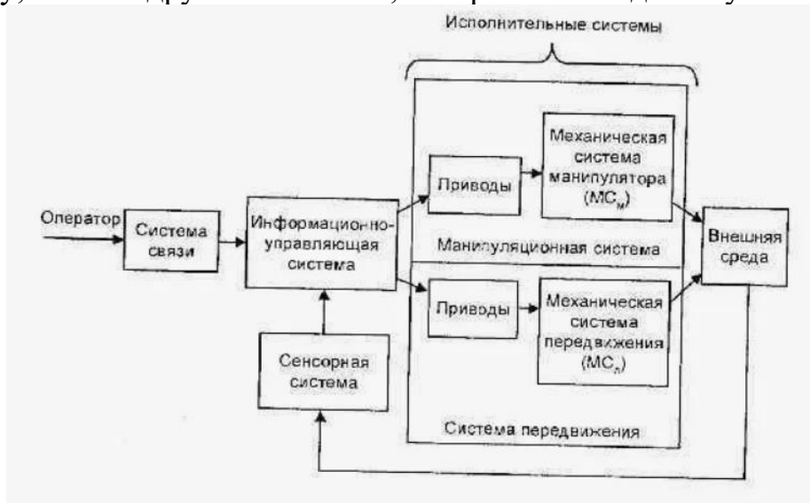
Рис. 1. Функциональная схема робота
