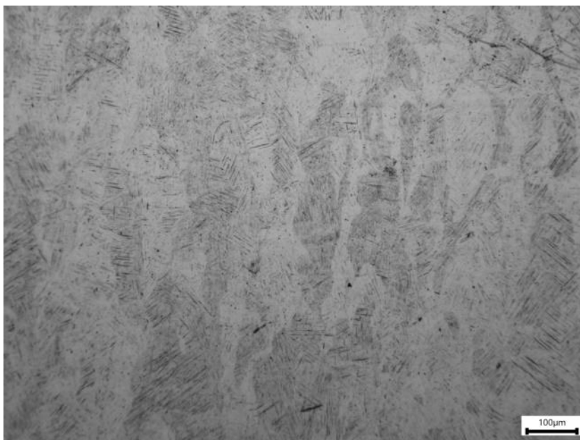
Рис. 1. Исходная структура сплава ВТ6, полученного методом селективного лазерного сплавления
