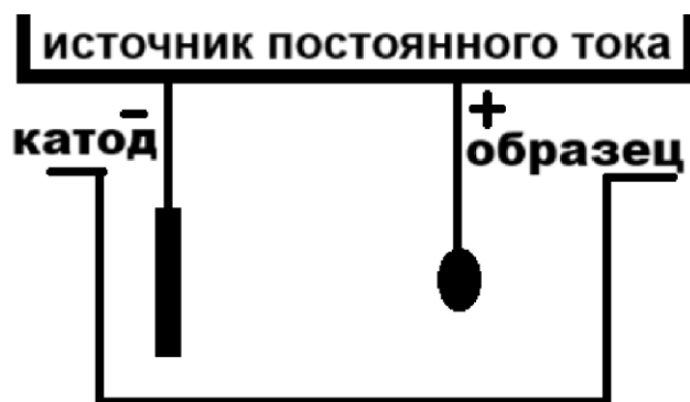
Рис. 1. Схема установки электролитно-плазменного полирования
