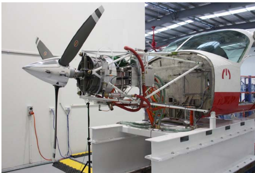
Рис. 1. Применение аксиального электродвигателя в самолете
