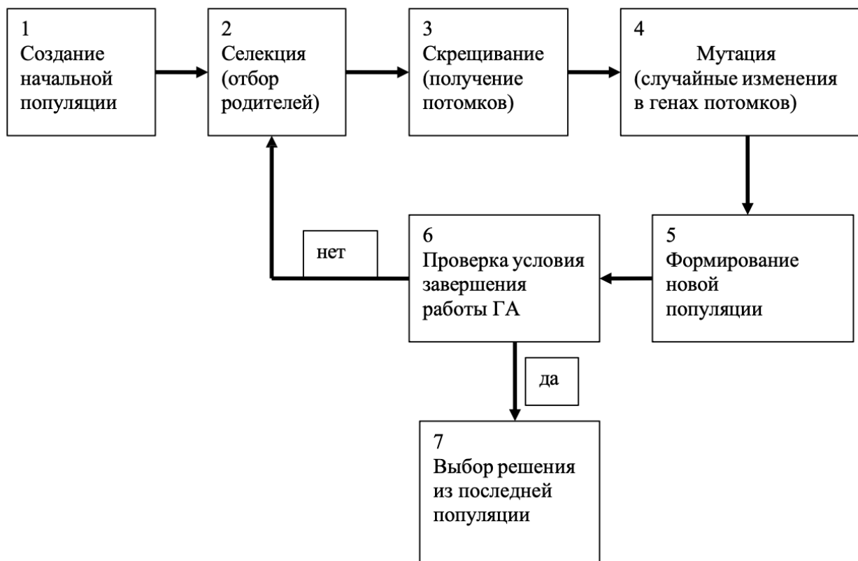
Рис. 2. Обобщенная блок-схема генетического алгоритма
