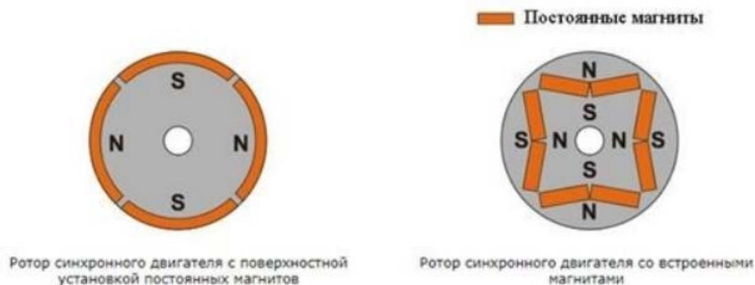
Рис. 32. Синхронный двигатель с возбуждением от постоянных магнитов
