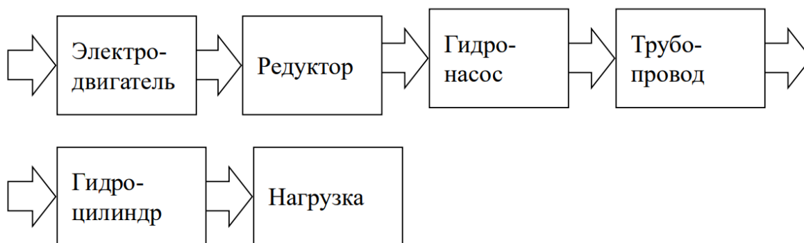
Рис. 29. Схема энергопреобразования в системе с гидроцилиндром
