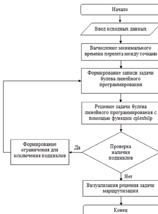
Рис. 1. Блок-схема алгоритма маршрутизации полета БПЛА с использованием процедуры последовательного запрета подциклов
