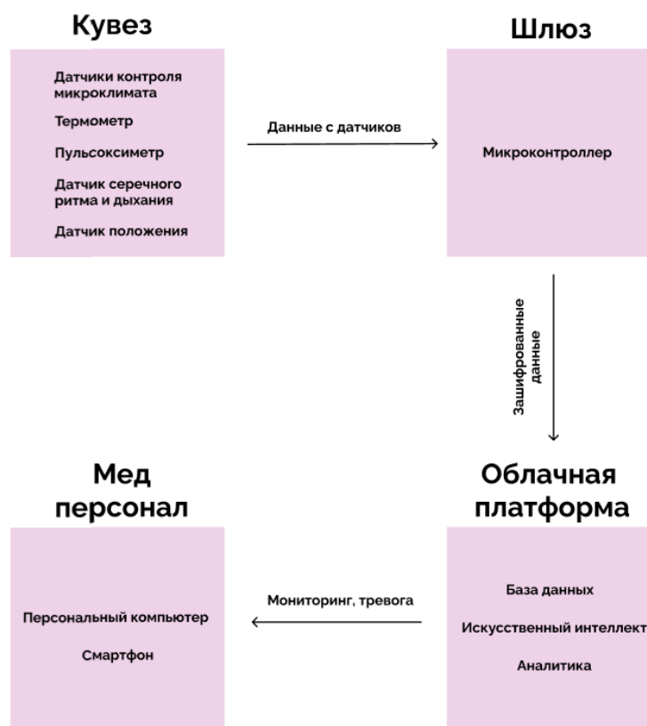
Рис. 13. Схематичное изображение архитектуры кувеза
