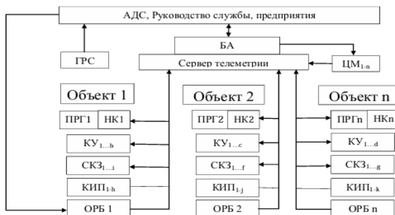
Рис. 1. Структура информационно-измерительной системы взаимосвязанных объектов газораспределительной сети на основе искусственного интеллекта: АДС – аварийно-диспетчерская служба, БА – блок аналитики, ГРС – газораспределительная станция, ПРГ – пункты редуцирования газа, НК – нейрокомпьютеры, КУ – крановые узлы, СКЗ – станции катодной защиты, КИП – контрольно-измерительные пункты, ОРБ – организационно-технический блок, ЦМ – цифровая модель
