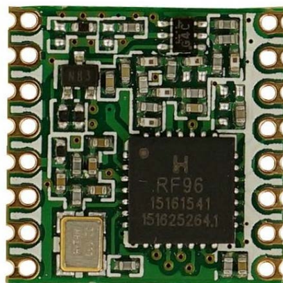
Рис. 4. Внешний вид модуля RFM-96W
