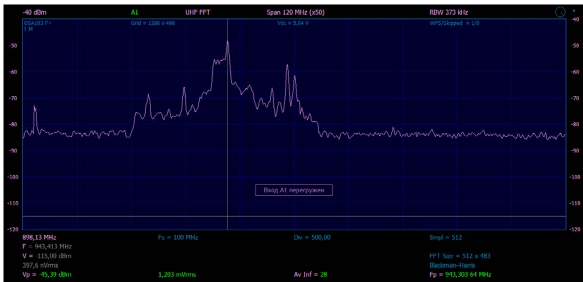
Рис. 6. Спектр сигнала GSM (900 МГц) при окне Блэкмана-Харриса
