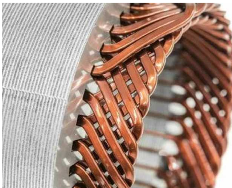
Рис. 3. Обмоточный провод прямоугольного сечения в пазу статора
