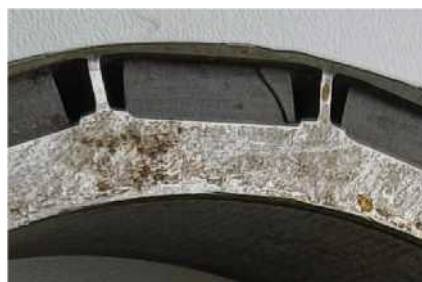
Рис. 2. Пакет ротора: трещина в магните
