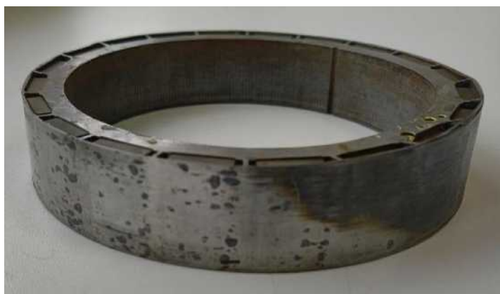
Рис. 1. Пакет ротора: зона локального повреждения
