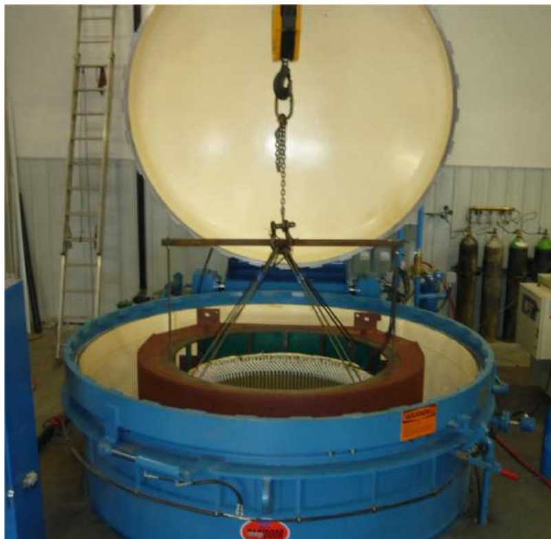
Рис. 5. Процесс вакуумной пропитки статора в специальных баках
