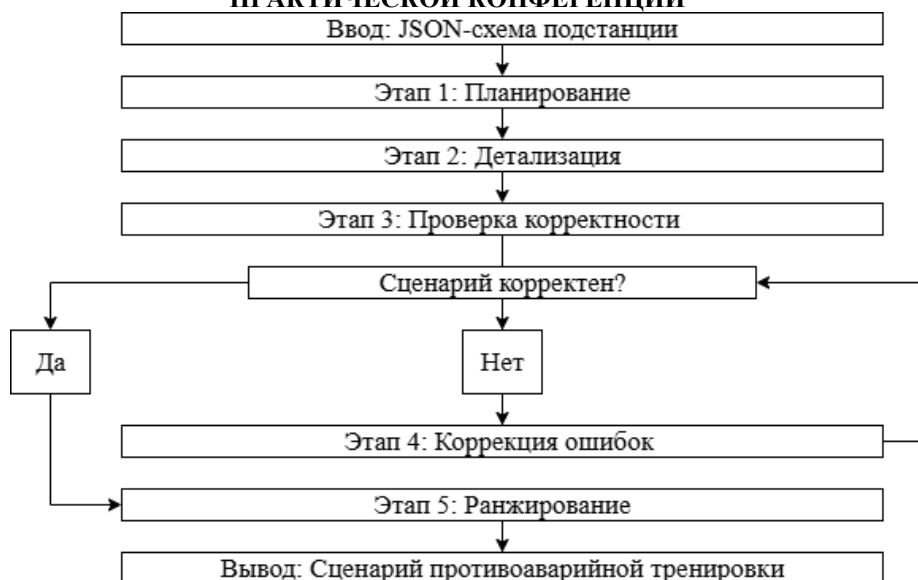
Рисунок 2 – Алгоритм генерации сценария противоаварийной тренировки
