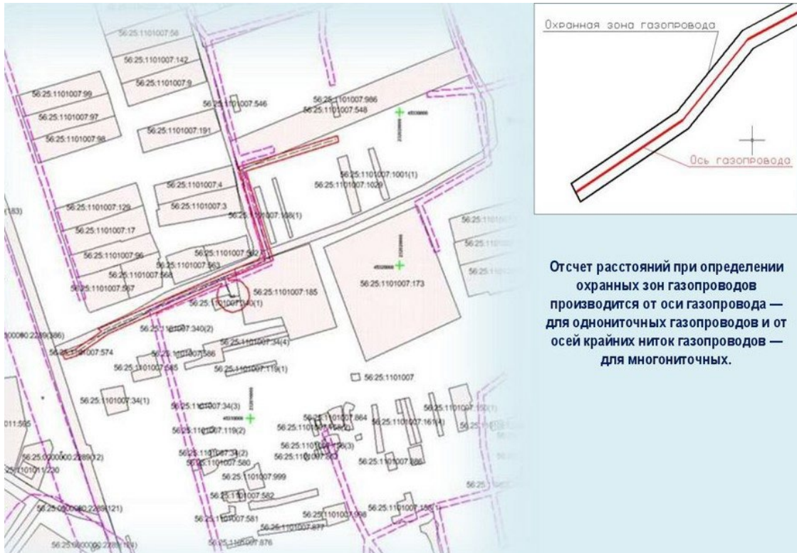
Рис. 1. Пример оформления чертежа охранной зоны газопроводов
