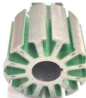
Рисунок 3 – Пакет статора с «замками»
