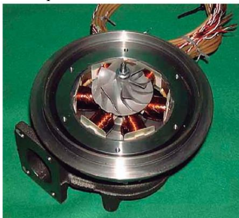
Рисунок 1.1.3 - электродвигатель гибридного нагнетателя
