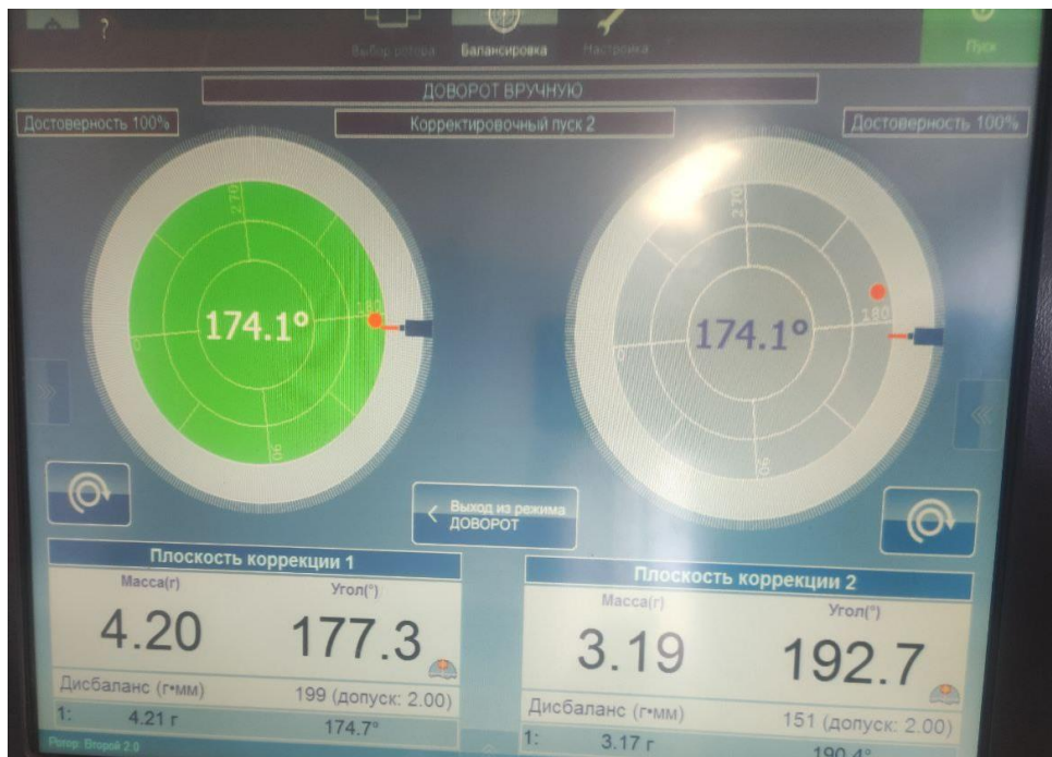
Рисунок 1 – Значения дисбаланса и корректирующей массы жесткого ротора электрогенератора по 2м плоскостям коррекции, выраженное в (г*мм) и (г)
