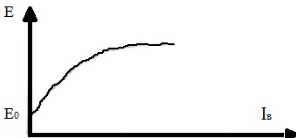
Рисунок 1 – Характеристика холостого хода синхронного генератора
