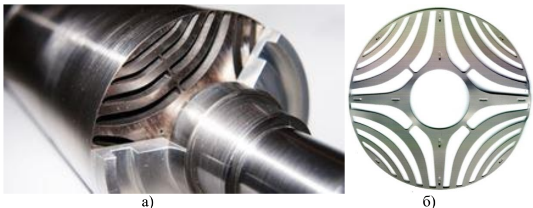
Рисунок 2 – Ротор синхронной электрической машины: а – структура магнитопровода; б – лист набора ротора, [1]
