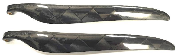
Рисунок 4 – Воздушный винт марки DUALSKY 18x13
