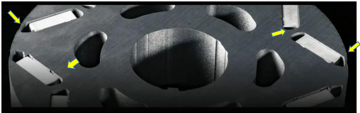
Рисунок 1 – Конструкции роторов синхронной электрической машины.
