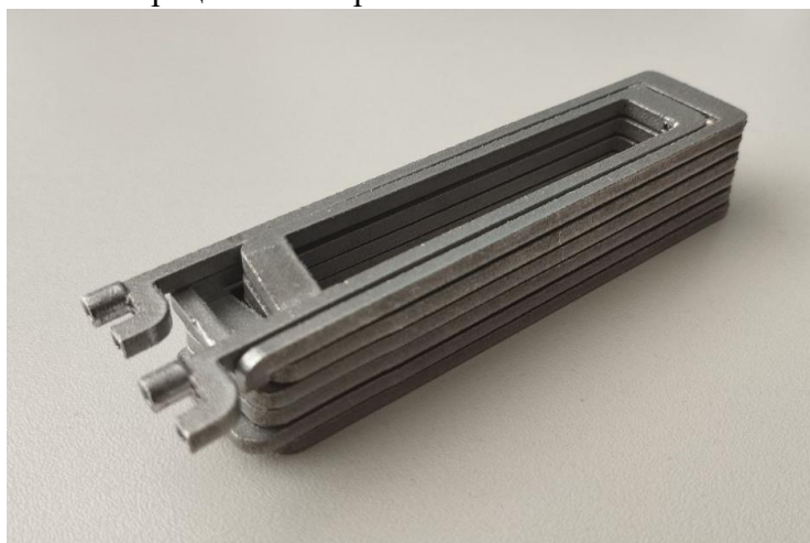
Рисунок 3 – Аддитивно изготовленная катушка после постобработки
