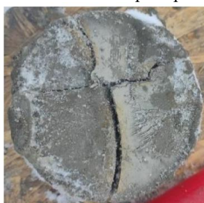
Б. Суглинок песчаный, слабо льдистый (3-20%), при оттаивании текучий
