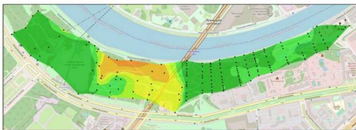
Плановые смещения в период с 2012 по 2022 гг., мм менее 30 30 - 60 60 - 90 90 - 120 120 - 150 более 150 • Деформационный знак
