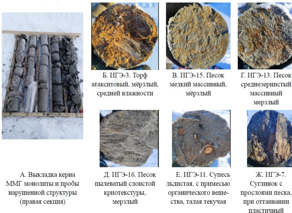
Рис. 2. Выкладка керна колонковых скважин монолитов и материала с нарушенной структурой (А). Литотипы ММГ некоторых ИГЭ разреза криолитозоны объекта изысканий
