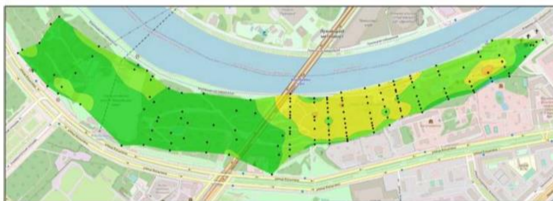
Высотные смещения в период с 2012 по 2022 гг., мм менее -20 -20 - -10 -10 - 0 0 - 10 более 10 • Деформационный знак
