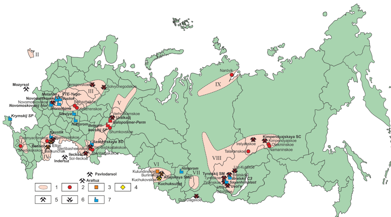
Рис. 2. Соленосные провинции, предприятия, добывающие и перерабатывающие соляные продукты: 1 – соленосные бассейны (I – Предкавказский, II – Калининградский [часть Центрально-Европейского], III – Московский, IV – Прикаспийский, V – Приуральский [Верхнекамский], VI – Южно-Сибирский [Барабино-Кулундинский], VII – Минусинский, VIII – Восточно-Сибирский [Ангаро-Ленский], IX – Хатангский), 2–4 – месторождения (2 – каменной соли, 3 – самосадочной [озерной] поваренной соли, 4 – сульфатов натрия), 5, 6 – горнодобывающие предприятия, реализующие минеральные соли (5 – действующие, 6 – остановленные), 7 – химические предприятия по переработке соляного сырья (Боярко Г.Ю. и др. 2021).
