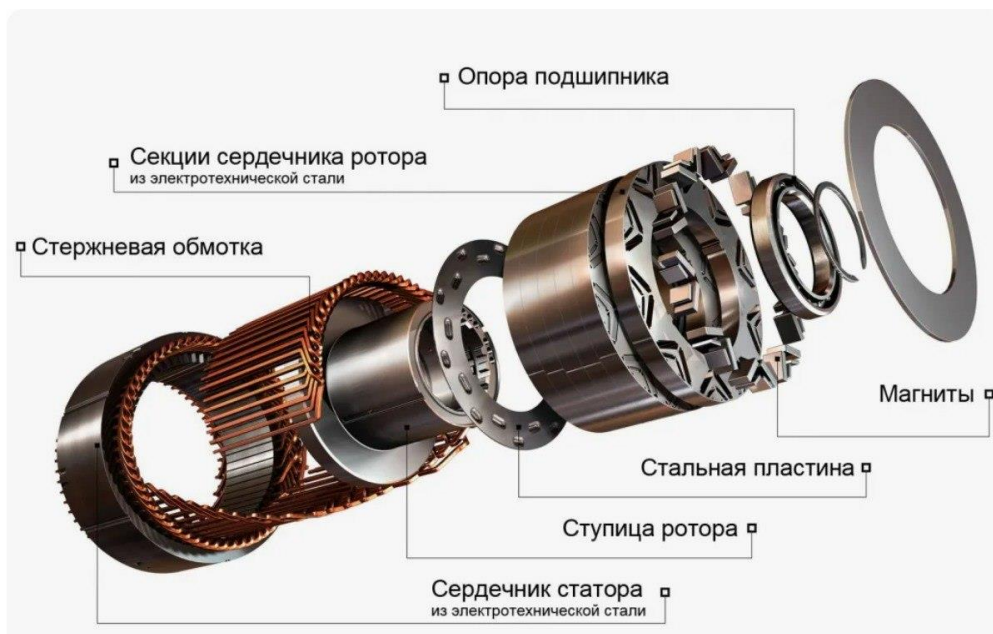
Рис. 1. Конструкция электродвигателя с постоянными магнитами
