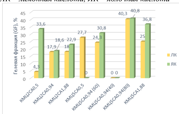
Рис. 2. Результаты испытаний полученных гидрогелей на основе КМЦ и сшивающих агентов (СА) на гелевую фракцию. Примечание: ЛК – лимонная кислота, ЯК – яблочная кислота
