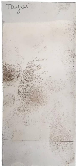
Рис. 1. Хроматографическая пластина с пятнами пестицида
