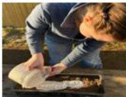
Рис. 1. Изготовление гипсового слепка следа обуви в песчаной поверхности
