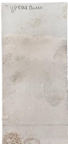
Рис. 1. Хроматографическая пластина с пятнами пестицида
