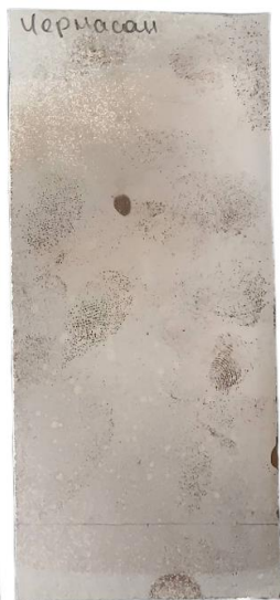
Рис. 1. Хроматографическая пластина с пятнами пестицида
