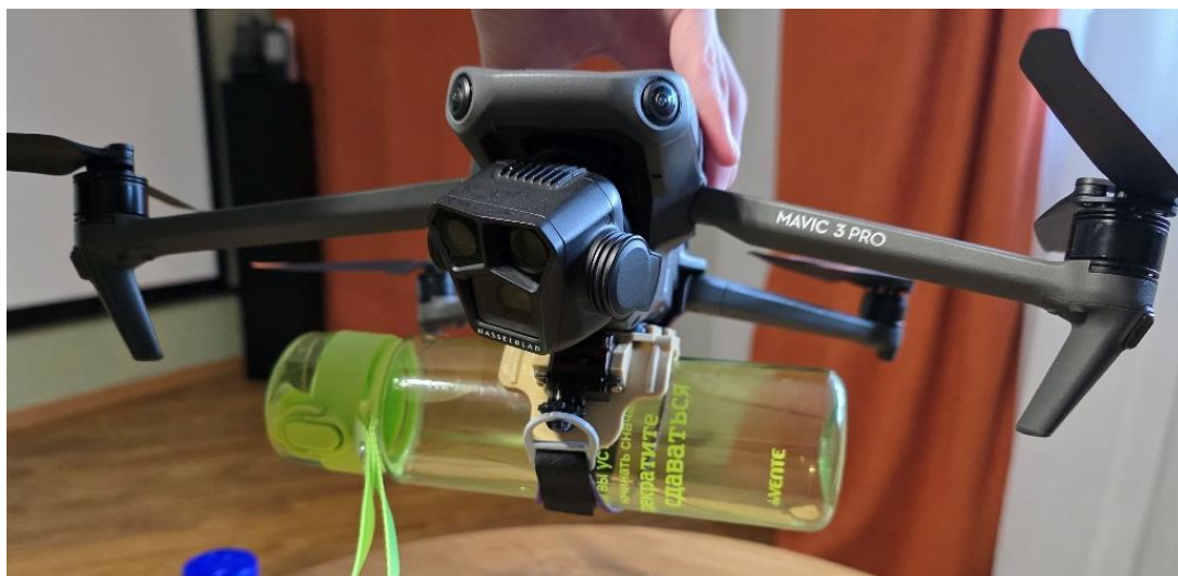
Рис. 5. внешний вид БПЛА с установленной системой сброса полезной нагрузки (закреплена бутылка с водой)
