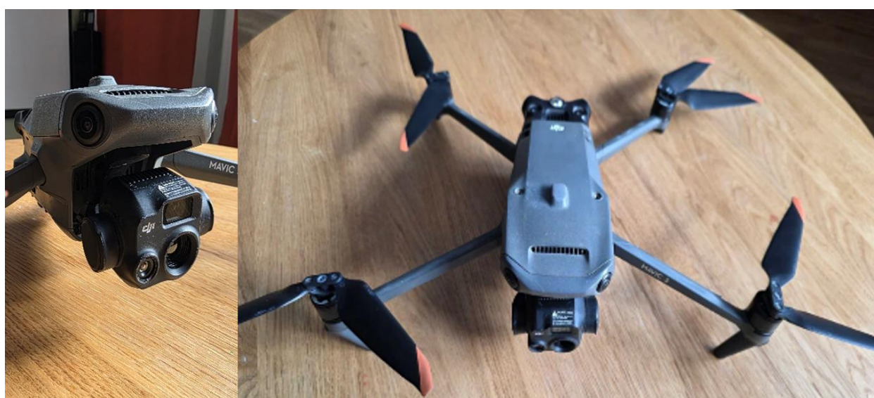
Рис. 1. внешний вид БПЛА DJI MAVIC-3T с инфракрасной камерой
