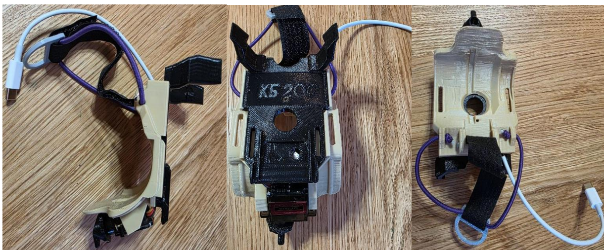
Рис. 1. внешний вид модернизированной системы сброса «Курьер» для доставки продуктов питания
