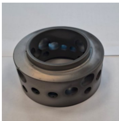
Рисунок 1. Запорно-регулирующий клапан (1) и азотированная втулка при режиме 580 °С, 12ч (2)
