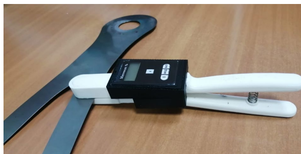
Рисунок 1 – Приспособление для определения объемной доли мартенсита
