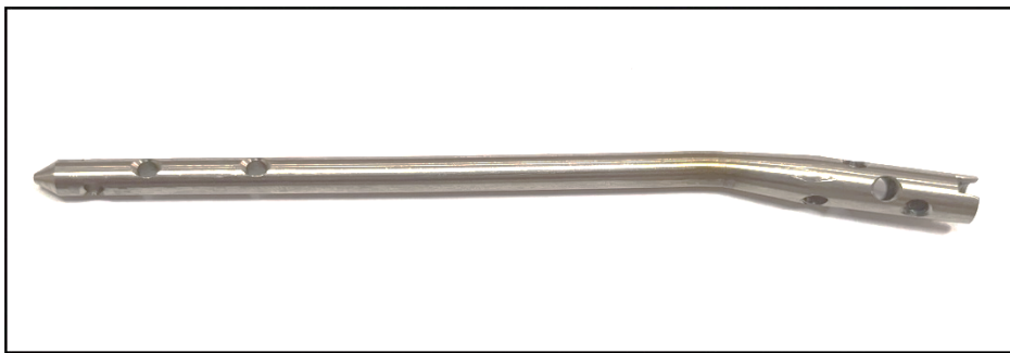
Рисунок 2. Согнутый с током плечевой стержень из УМЗ ВТ1-0
