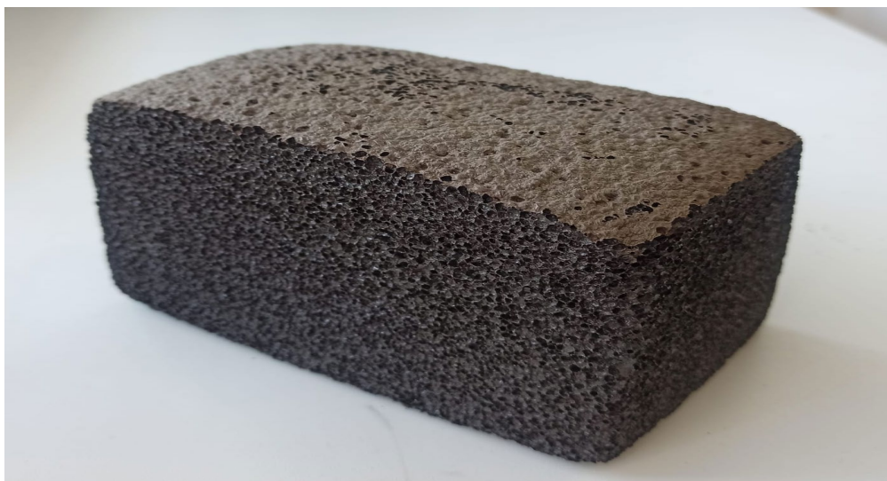
Рисунок 1. Блок пенокерамики на основе глиняного сырья.
