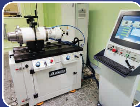
Стенд испытаний шпиндельных узлов СТШ-500
