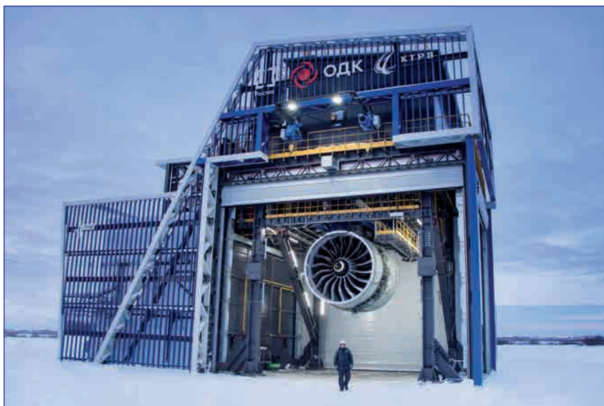
Двигатель-демонстратор технологий ПД-35 на открытом испытательном стенде АО «ОДК-Авиадвигатель»
