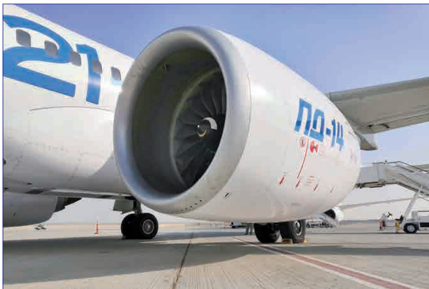
Двигатель ПД-14 на крыле авиалайнера МС-21-310, авиасалон Dubai Airshow
