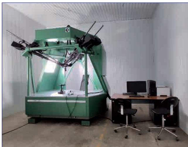
Контрольно-измерительная машина для измерения геометрических размеров деталей авиадвигателей
