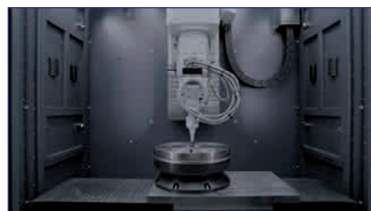
Конфигурация для пятикоординатной обработки и резки под углом
