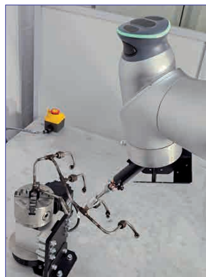
Роботизированная система выявления прижогов и исследования напряжённо-деформированного состояния ферромагнитных ДСЕ на основе эффекта Баркгаузена.
