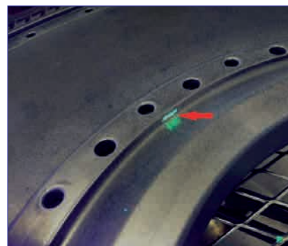
Результат контроля диска ГТД на установке КАМА-1200
