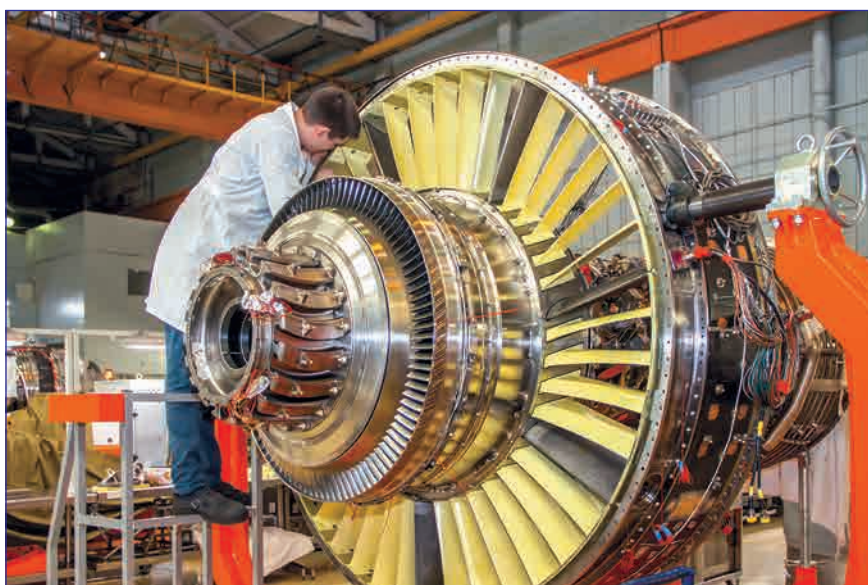
Авиационный двигатель ПД-14 в сборочном цехе АО «ОДК-ПМ»
