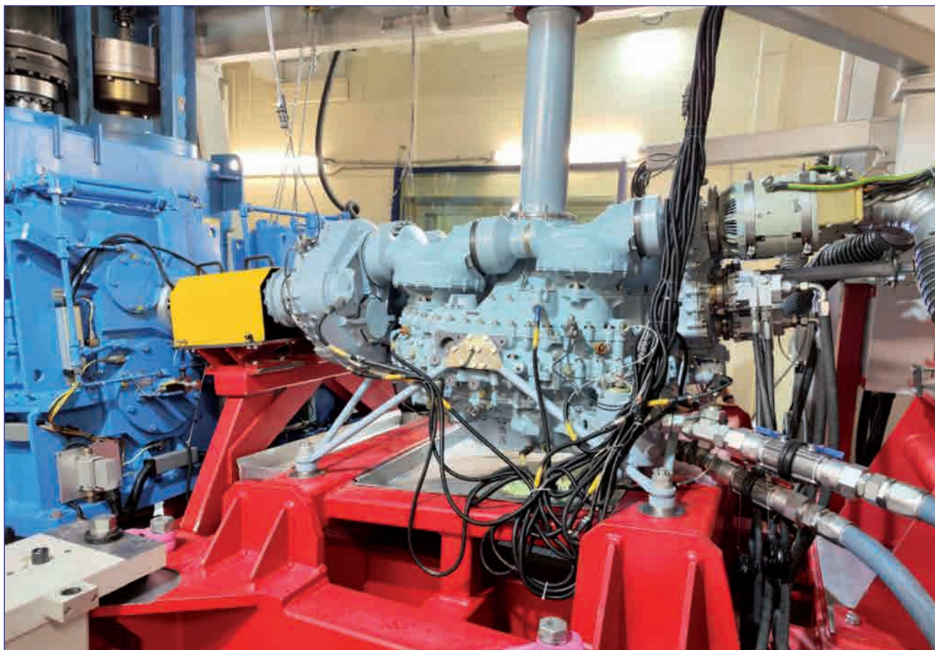
Редуктор ВР-382 на стенде
