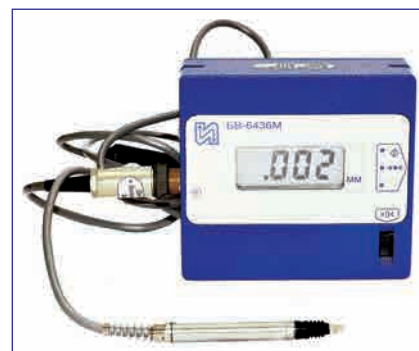
Система измерительная портативная и индуктивным преобразователем мод. БВ-6436М
