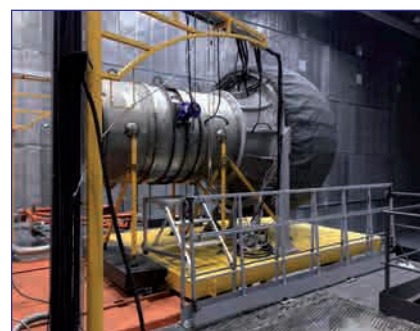
Двигатель Д-36 на стенде для проведения испытаний
