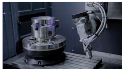
Бесконтактный обмер заготовки для совмещения системы координат
