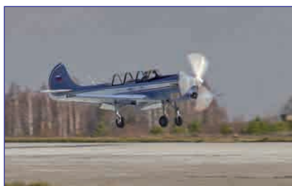
Завершены работы в рамках создания демонстратора перспективного авиационного поршневого двигателя, который прошел комплекс наземных и летных испытаний. По итогам подготовлен проект ТЗ на разработку АД для самолетов акробатической категории.
