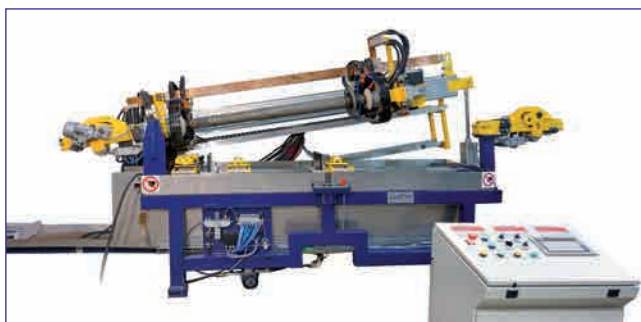
ЕрМаг 2500 для контроля полых авиационных валов
