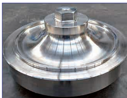
Диск-вал из гранул сложнoleгированных жаропрочных никелевых сплавов
