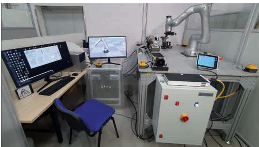
Роботизированная система выявления прижогов и исследования напряжённо-деформированного состояния ферромагнитных ДСЕ на основе эффекта Баркгаузена.
