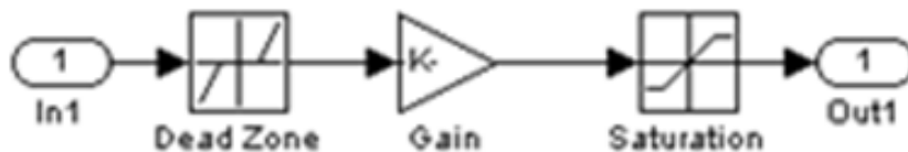
Рис. 2.10. Схема моделирования усилителя с ограничением и зоной нечувствительности
