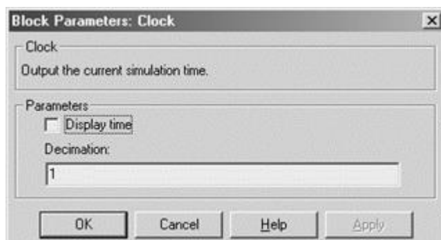
Рис. 2.7. Настройки блока Clock
