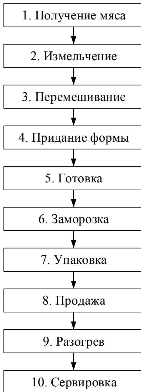
Рис. А1. Блок-схема технологических операций производства замороженных говяжьих котлет
