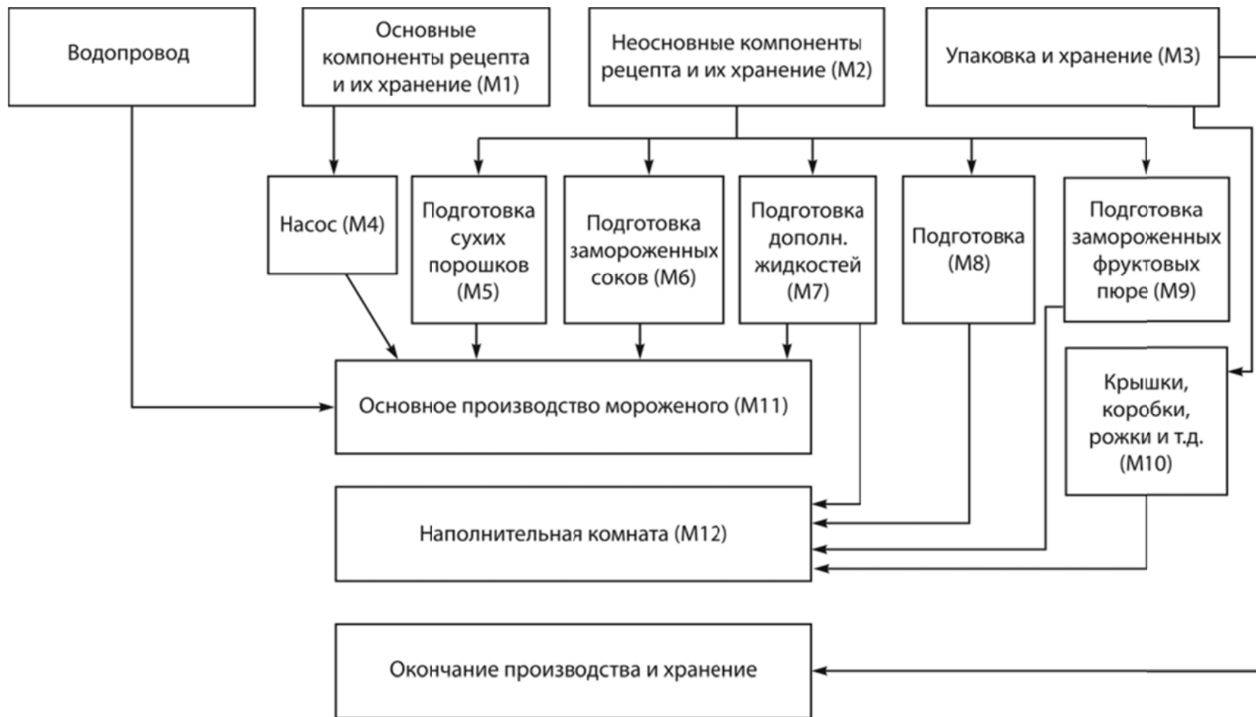
Рис. 1.1. Блок-схема технологического процесса производства мороженого с использованием модульного подхода
