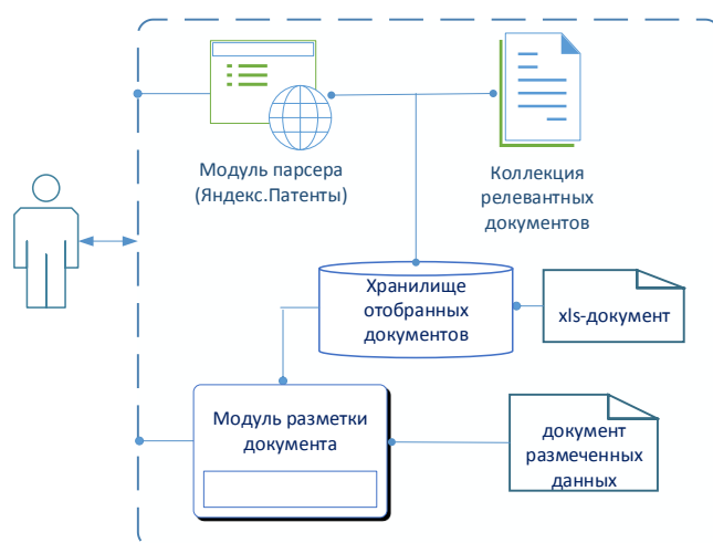
Рис. 1. Архитектура приложения для парсинга сайтов и автоматической разметки документа
