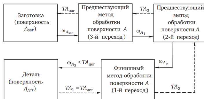
Рис. 1. Схема определения необходимого количества переходов по обработке поверхности А детали
