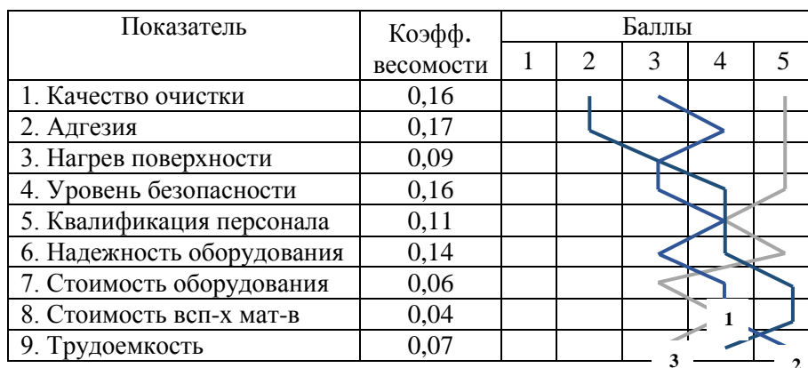
Рис. 4. Оценка метода предварительной обработки получения алюминиевых покрытий 1 – тлеющий разряд (1); 2 – эффект полого катода; 3 – ПИНК
