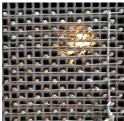
Рис. 1. Озонатор сотовой структуры, вид во фронтальном разрезе
