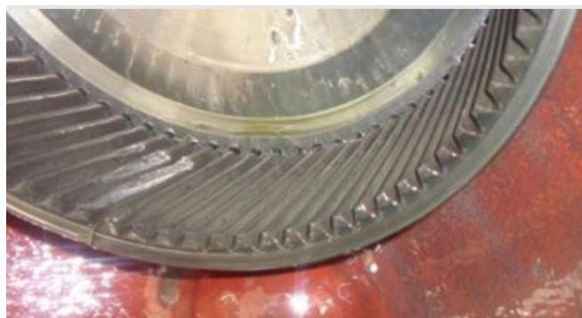
Рис. 7. Поломка зубьев колесного редуктора
