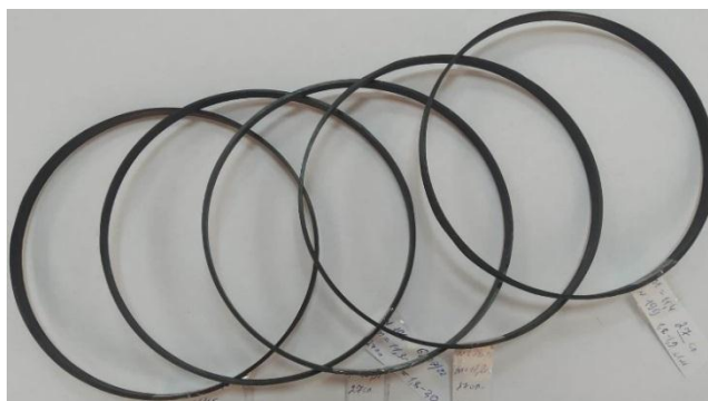
Рис. 6. Кольцевые образцы для испытаний на растяжение
