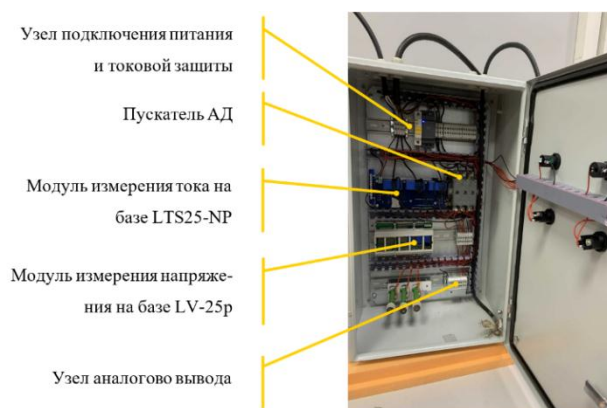
Рис. 12. Система управления экспериментального стенда
