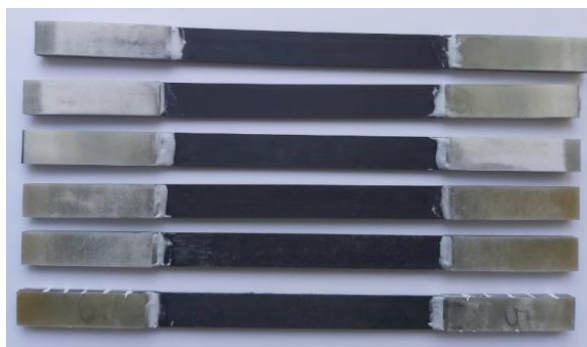
Рис. 3. Плоские образцы для испытаний на растяжение вдоль волокон
