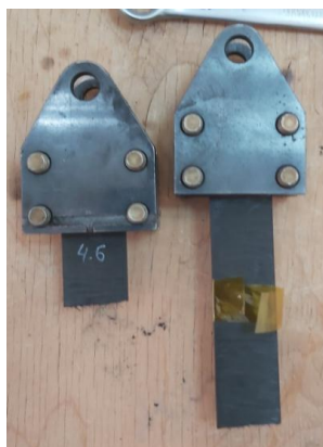
Рис. 9. Образец после разрушения при растяжении поперек волокон
