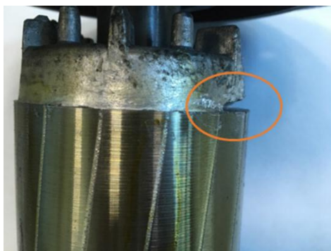
Рис. 11. Ротор исследуемого двигателя с повреждением двух стержней
