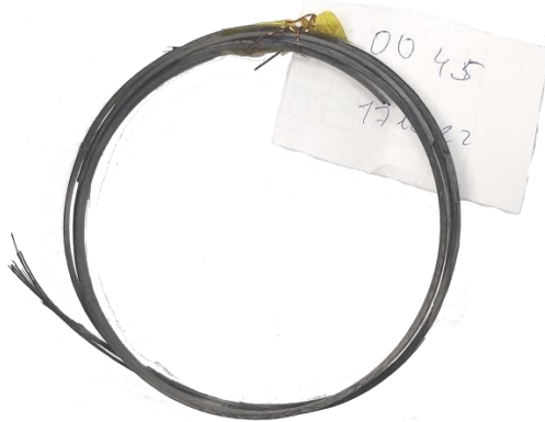
Рис. 12. Образец 45 после разрушения
