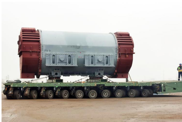
Рис. 1. Доставка статора турбогенератора ТВВ-1200-4У3 на площадку строительства станции [4]
