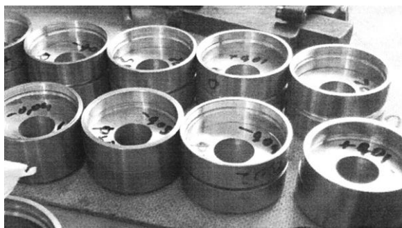
Рис. 8. Полюса и промежуточные кольца вторичного элемента
