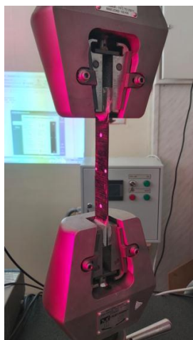
Рис. 2. Плоский образец с метками в зажимах при испытании
