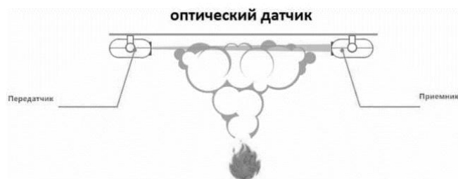
Рис. 2. Пример срабатывания оптического датчика дыма [3]
