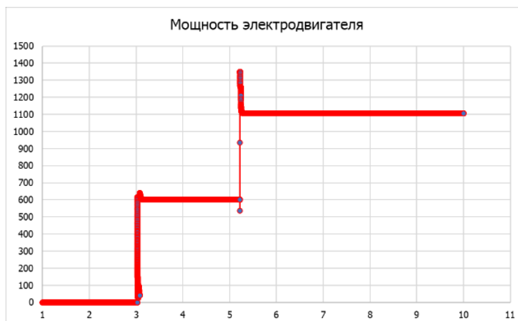
Рис. 12. Результаты моделирования: a – частота вращения; б – мощность турбины; в – мощность электродвигателя
