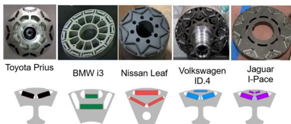
Рис. 9. Схемы роторов IPMSM двигателей серийных электромобилей
