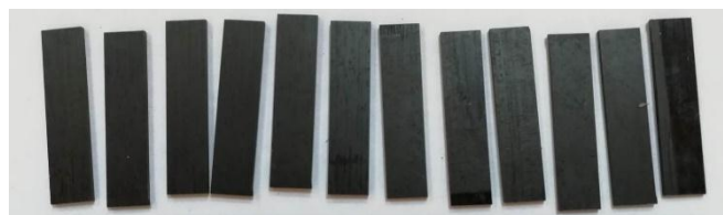
Рис. 5. Плоские образцы для испытаний на изгиб (поперек волокон)
