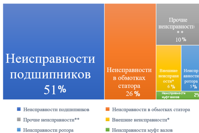
Рис. 1. Неисправности в электрических машинах:
