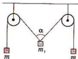
К концам нити, перекинутой через два блока, подвешены два одинаковых груза массами  $m=5$  кг каждый. Какой массой обладает груз  $m_1$ , если при равновесии  $\alpha=120^\circ$ ?
