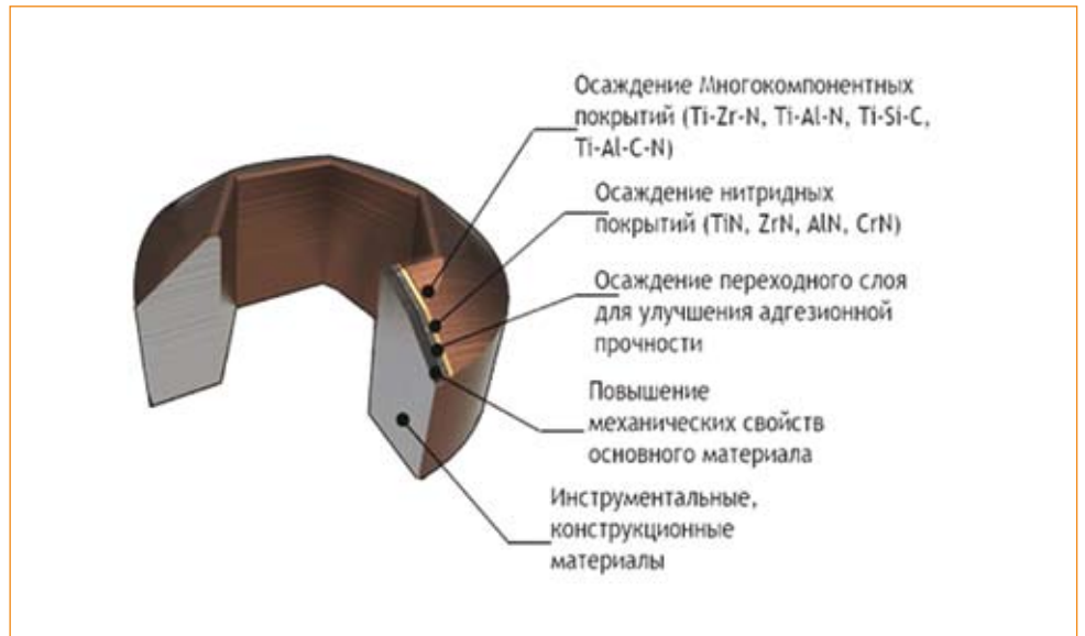
Структура мультислойных покрытий
