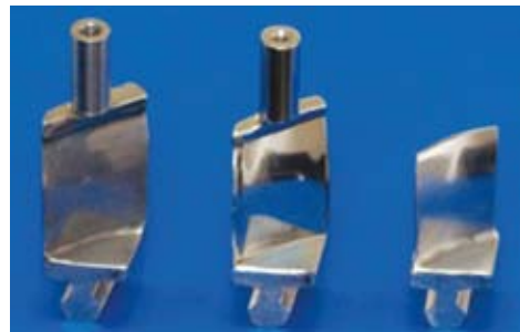
Лопатки компрессора, обработанные методом ЭХО
