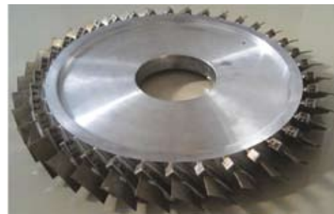
Экспериментальное монокоесо полученное линейной сваркой трением
