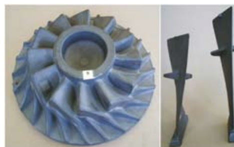
Примеры изделий, полученных точной штамповкой в режиме сверхпластичности
