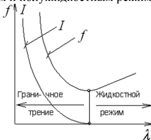
Рис. 4.1. Диаграмма Герси–Штрибека – зависимость коэффициента трения от характеристики \lambda = \eta V / N
