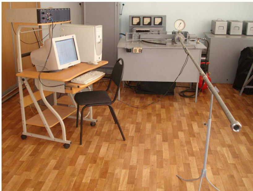
Рис. 7.8. Одноцикловая установка, трубопровод и система измерений
